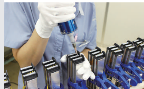
■ PTCヒータ防水処理工程
